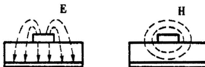
Figura 46 - Distribuzione di campo elettrico e magnetico di una microstriscia.
