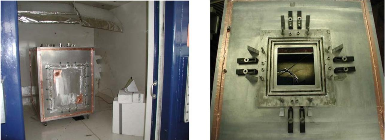
Figura 221 – Camere riverberanti del NIST (a sinistra) e apertura situata sulla superficie superiore della piccola camera riverberante sulla quale si pone il pannello di materiale da caratterizzare
