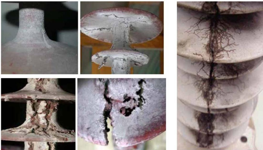
Figura 105 - Erosione superficiale e tracking sul alcuni isolatori.
