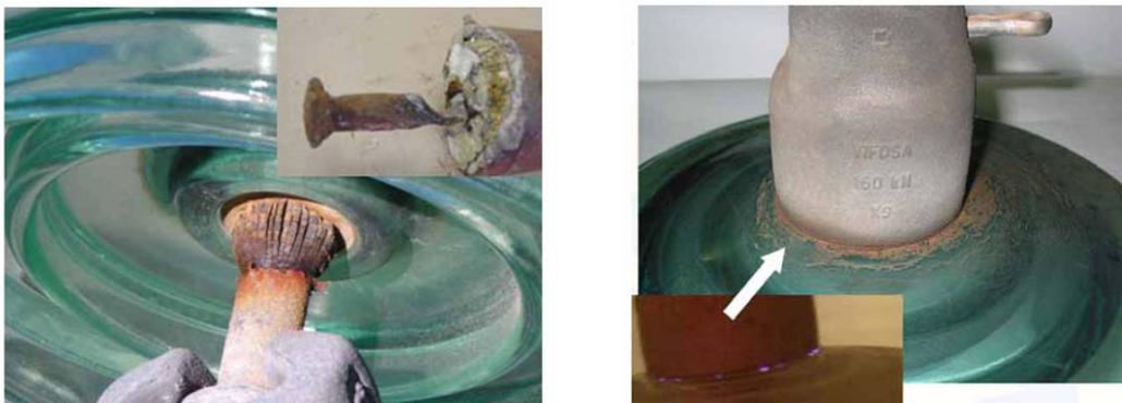
Figura 101 – Corrosione anodica del perno (a sx) e della cappa (a dx).
